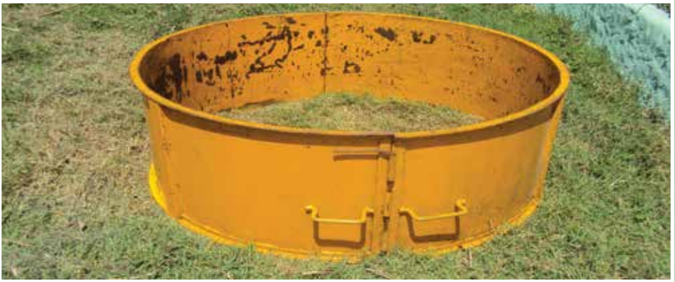
Figura 2. Anillo metálico con dimensión de 1.5 m de diámetro
