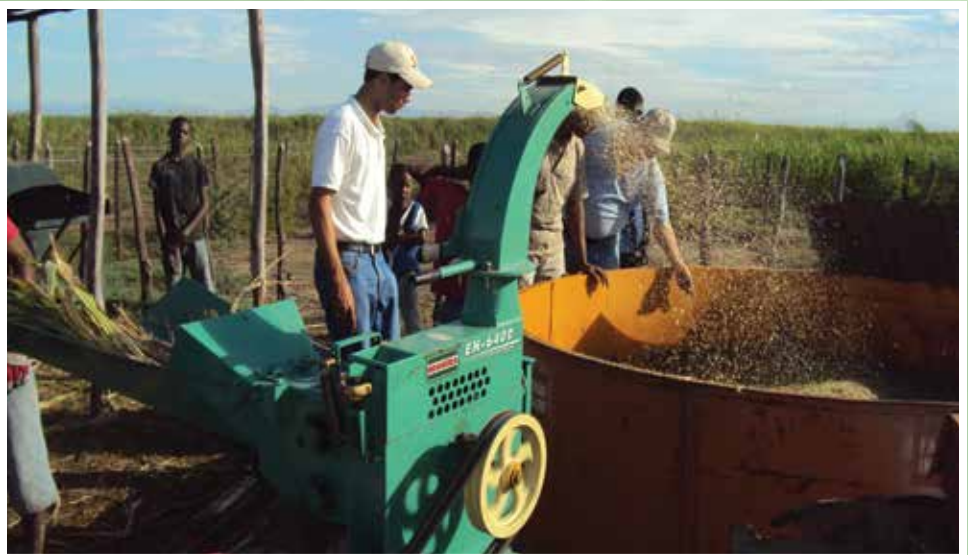
Figura 8. Picado del forraje para llenado del silo de anillo
